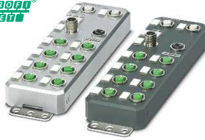
8 дискретных входов и 4 дискретных выхода
