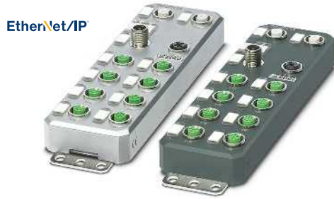
8 дискретных входов и 4 дискретных выхода
