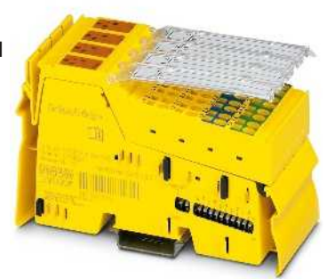
Подключение макс. к 16 входным/выходным модулям безопасности
