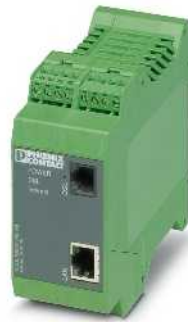
Маршрутизатор DSL/модем с межсетевым экраном
