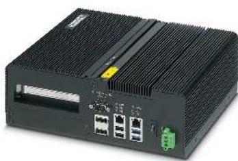
Блочный ПК с процессором Intel® Celeron® N2930 и слотом PCI/e
