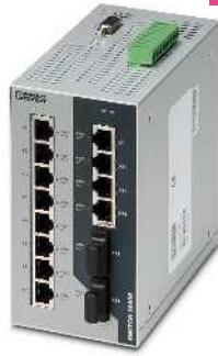
12 порта RJ45 и 2 оптических порта (одномодовые)
