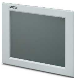
Панельный ПК с процессором Intel® Celeron® 1020E
