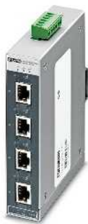
4 порта RJ45 и 1 оптический порт
