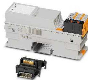
1 SSI-интерфейс для датчика абсолютных значений, 1 аналоговый выход
